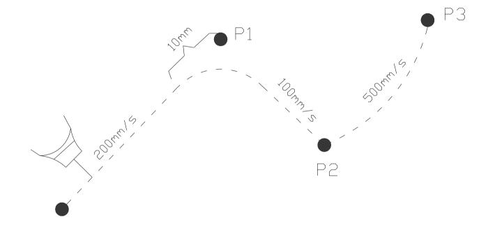
MoveL p1,v200,z10,tool1 MoveL p2,v100,fine,tool1 MoveJ p3,v500,fine,tool1
